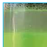
Refrigerante y aditivo con contaminación de agua
