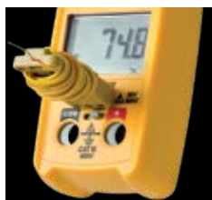
O termopar tipo K liga-se diretamente ao medidor
