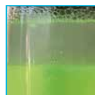
Refrigerante y aditivo con contaminación de agua
